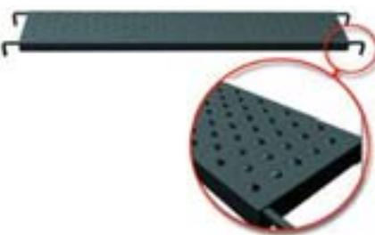
Настил выполнен из листовой стали и усилен каркасом из профильной трубы. На рабочей поверхности настила для повышения безопасности работ пробито множество отверстий с
