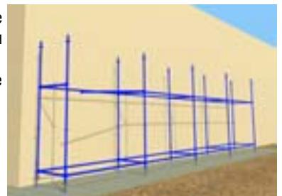
6. Для усиления жесткости конструкции закрепить диагональные элементы (см. Диагональный элемент).
